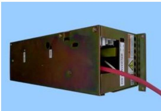
**众**兴 ZXR-500 高压电源是 X 光射线管专用电源，这种电源提供正高压或负高压。它集成了输出直流电压 5.5V，电流 0.3A 到 3.5A 可调的带有预热功能的灯丝电源。高压和灯丝电流可实现线性平稳上升。ZXR-500 电源还可以外接电位器实现输出电压和电流的远程控制，并且具有外接电压和电流显示、高压输出端过压和拉弧、短路保护、安全互锁等功能。可完美替代岛津 50KV50W 射线管电源
