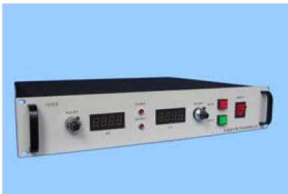
**众**兴 ZXR-700 高压电源是 X 光射线管专用电源，此系列电源提供正高压输出，它可安装于 19" 标准机柜，面板装有数字电压和电流表显示。可提供直流灯丝电压或交流灯丝电压。高压和灯丝电流均可实现线性平稳上升。ZXR-700 电源还可外接电位器实现输出电压和电流的远程控制，并且具有外接电压和电流显示端口、短路保护、安全互锁等功能。
