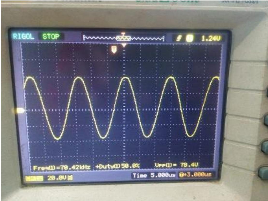
12、75KHz 时的电压取样波形如下：
