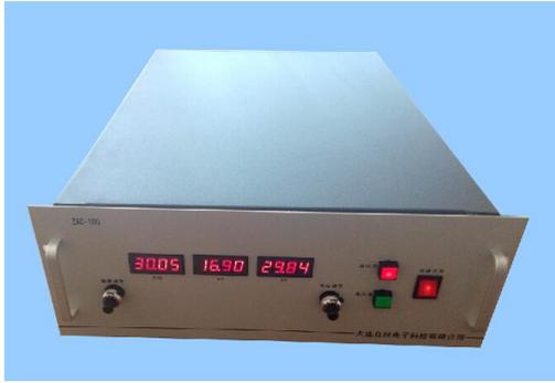
**众**兴 ZAC-100 高压电源是标准机箱系列电源，此系列电源提供正或负高压输出，它可安装于 19" 标准机柜，面板装有数字电压和电流表和频率表显示。高压和电流均可实现线性平稳上升。电压调节旋钮采用计数式十圈电位器，可精确定位输出电压到设定值。ZAC-100 电源还可外接电位器实现输出电压的远程控制，并且具有外接电压和电流显示端口、短路保护、安全互锁等功能。
