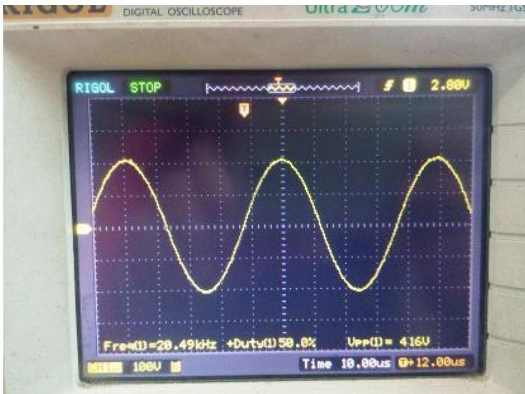
4、25KHz 时的电压取样波形如下：
