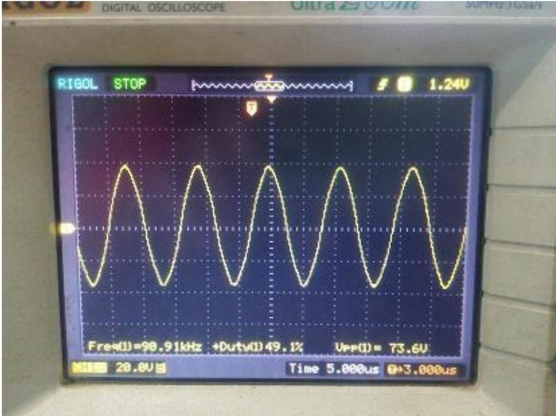
14、100KHz 时的电压取样波形如下：
